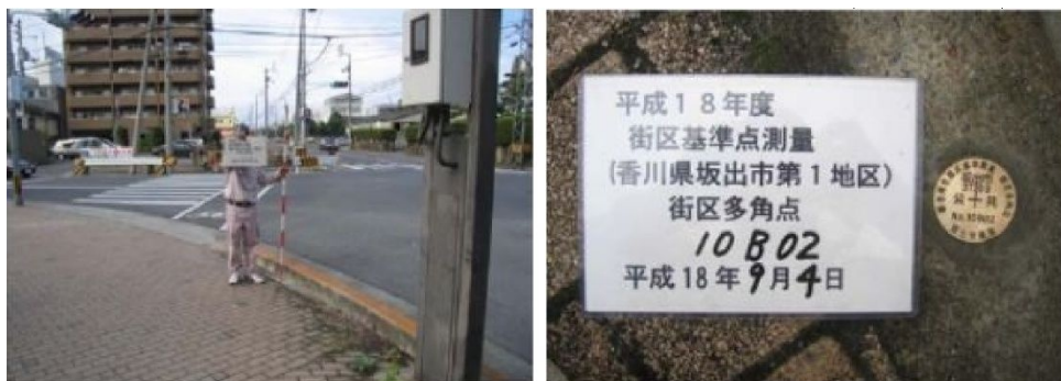
写真-4.1.1 公共基準点（街区多角点 10B02、標高 GH=0.995m）
