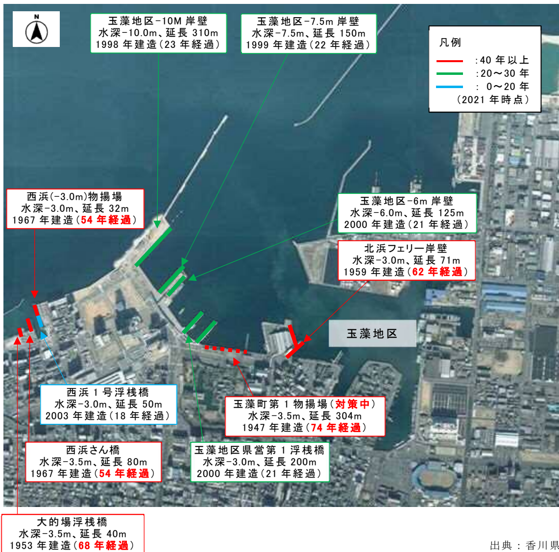
図表 1-55 港湾施設の老朽化（玉藻地区）
