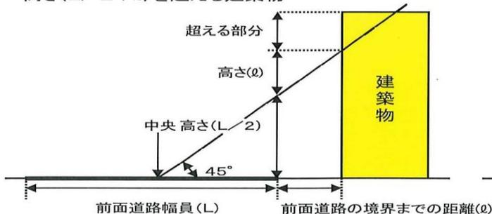
②前面道路幅員が12m以下の場合は6mに前面道路の境界までの距離(ℓ)を加えた高さ(6+ℓ)を超える建築物
