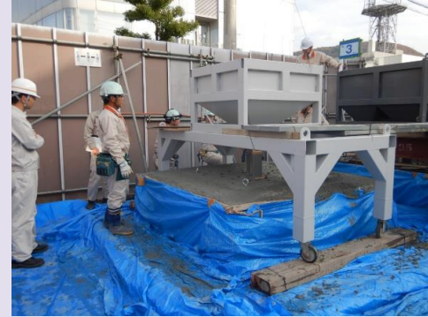
免震部分についての実物大試験の様子です。
