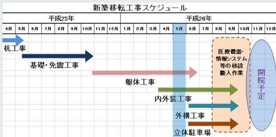
4月末にて、1・2階立上り躯体のコンクリート打設が完了し、3階立上り躯体についても30%程度完了しております。また、1階については、各種設備工事や内装仕上げを進めております。5月は、3階立上り躯体のコンクリート打設、1・2階内装仕上げと共に、外壁部分の工事に着手していく予定です。また、救急搬入路等の外構工事についても随時着手していきます。
