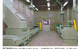
手選別コンベヤ(プラスチック類用:左、PETボトル用:右) 搬入されたPETボトルおよびプラスチック類の中から不測物を手選別により除去します。
