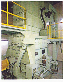
破碎機 横型回転式破碎機により効率よくごみを破碎します。
