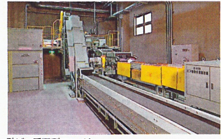
駄ビン手選別コンベヤ 白、茶、その他のビンの中から不測物および手選別により除去・回収します。
