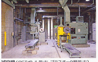
減容機(PETボトル用:左、プラスチック類用:右) 不測物を除去された、PETボトルおよびプラスチック類を圧縮、梱包します。
